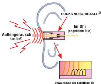
**Eine höhere Dämmwirkung** in ruhigerer Umgebung, wie z. B. im Flugzeug oder im Büro, wie auch bei hohem Dauerlärm wird erreicht, indem der angebrachte Akustik-Stopper in das Akustikfilter eingesetzt wird.
